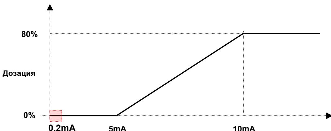
Пример: **Обратно** пропорциональное дозирование по токовому сигналу: Значение mA для 0% = 10mA
