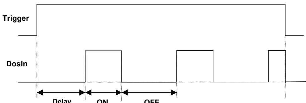
Ist kein Trigger ausgewählt, beginnt die Pumpe nach dem Einschalten mit dem Countdown der Verzögerung.
