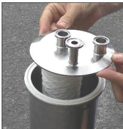
5. Verrouiller la plaque en fermant le tri-clamp.
